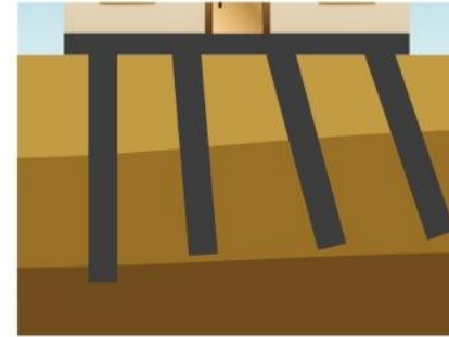
鋼管杭工法の場合
