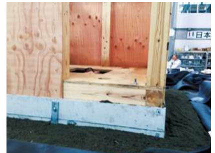
スーパージオ®SG300では液状化なし、建物の傾きなし、液状化による噴砂なし
